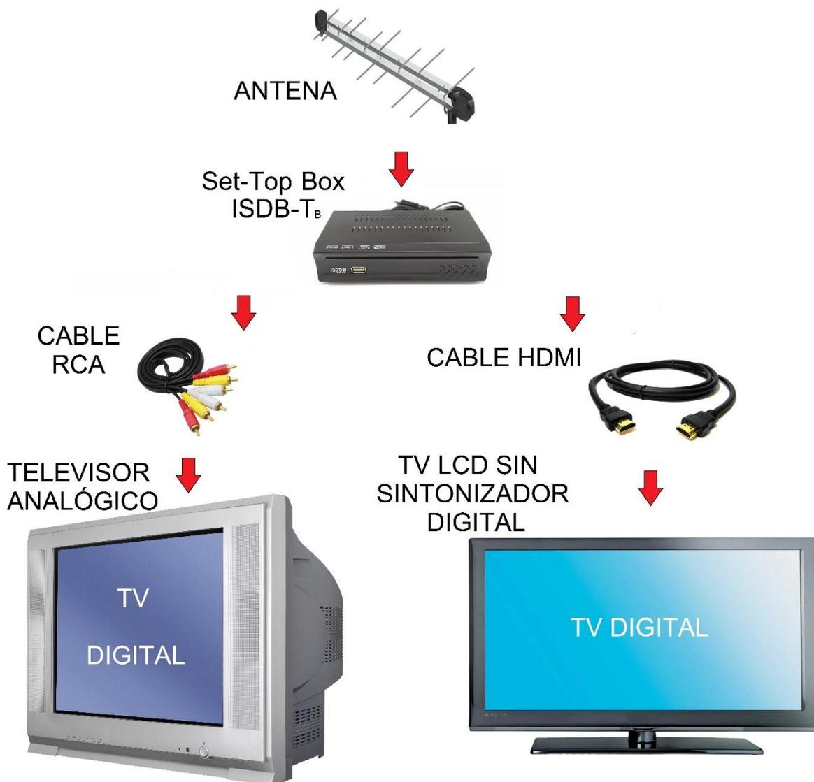
Ilustración 3. Casos en donde los televisores no posean un Sintonizador de TV Digital ISDBT<sub>B</sub>.
