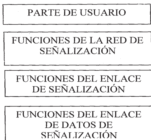
FIGURA 1: ESTRUCTURA DE CAPAS DEL SISTEMA DE SEÑALIZACIÓN SS7
